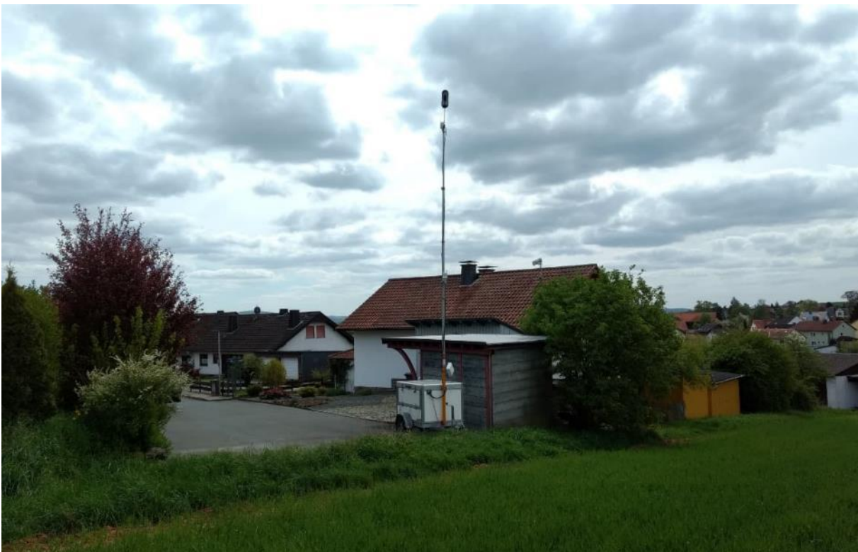
Abbildung 20: Messaufbau im Immissionsbereich der Windenergieanlagen
