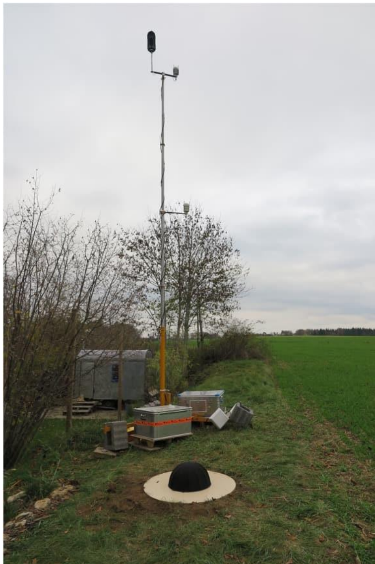
Abbildung 51: Messung auf Bodenplatte neben der Messung auf einem Stativ
