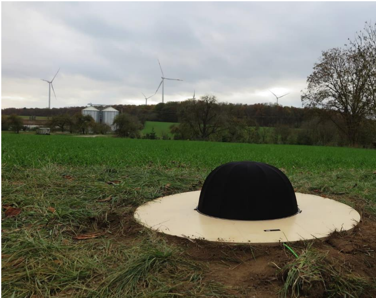
Abbildung 38: Infraschallmikrofon auf Bodenplatte
