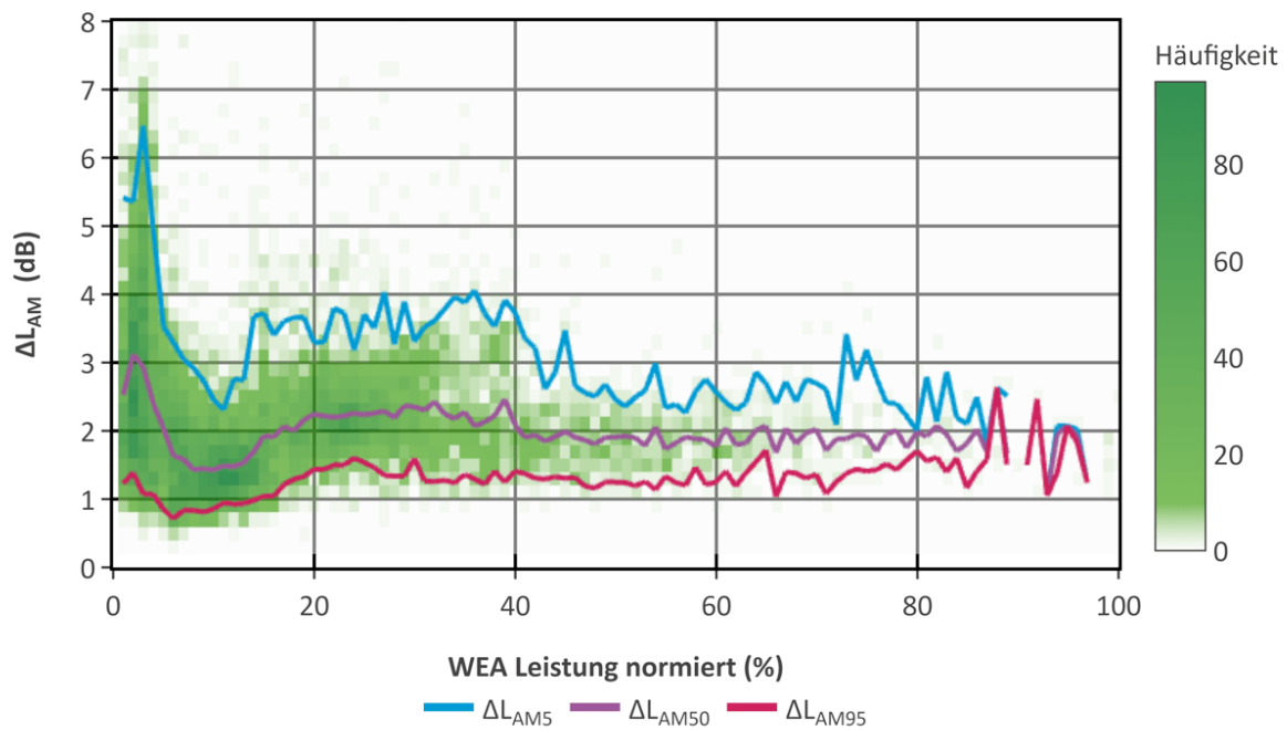
Abbildung 122: UG 1, Emission, Modulationstiefe der Amplitudenmodulation (5, 50 und 95 Perzentil) und Leistung der Windenergieanlagen (normiert)
